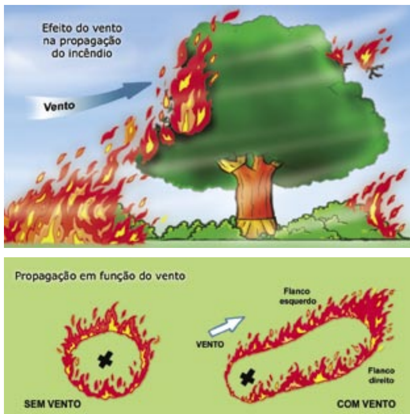
Fig. 15 Acção do vento na propagação de um incêndio florestal.
