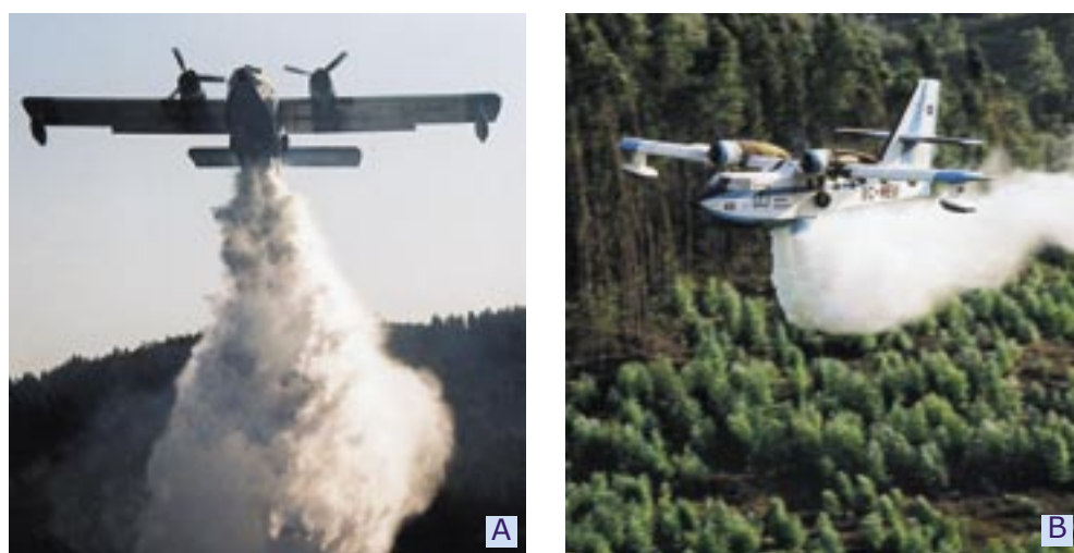
Fig. 55 Quando um avião se apresenta de frente é grande o perigo de ser afectado pelo seu lançamento. A – De frente; B – De lado.
