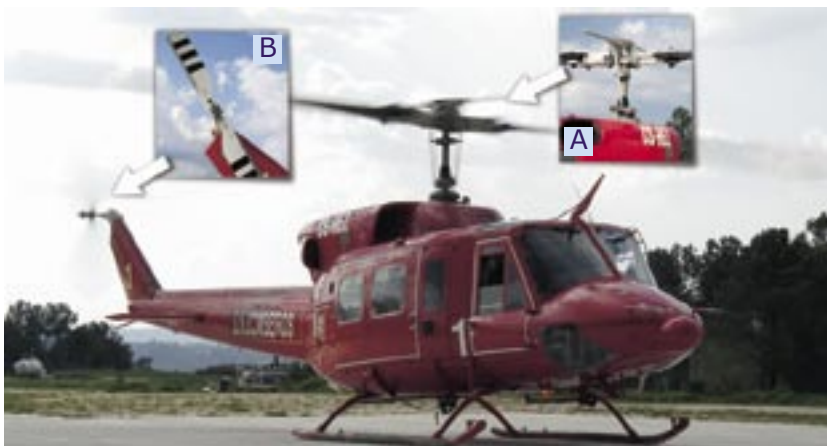
Fig. 57 Rotores de um helicóptero. A – Rotor principal; B – Rotor de cauda.
