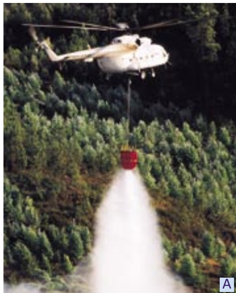
Fig. 19 Helicópteros utilizados nos incêndios florestais. A – Helicóptero bombardeiro pesado com balde; B – Helicóptero bombardeiro leve com tanque.
