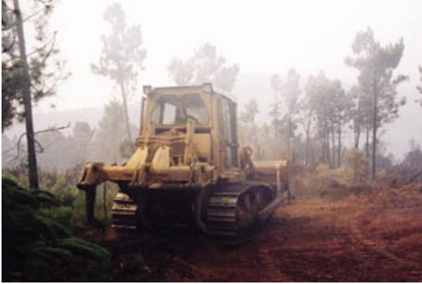
Fig. 35 Abertura de faixa de contenção recorrendo a uma máquina de rasto com lâmina.
