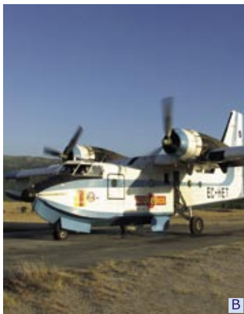
Fig. 20 Exemplos de aerotanques utilizados no combate a incêndios florestais. A – Aerotanque leve; B – Aerotanque pesado.
