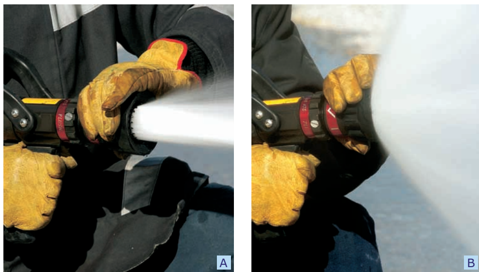
Fig. 20 Exemplo de duas formas de aplicação da água. A – Em jacto; B – Pulverizada.
