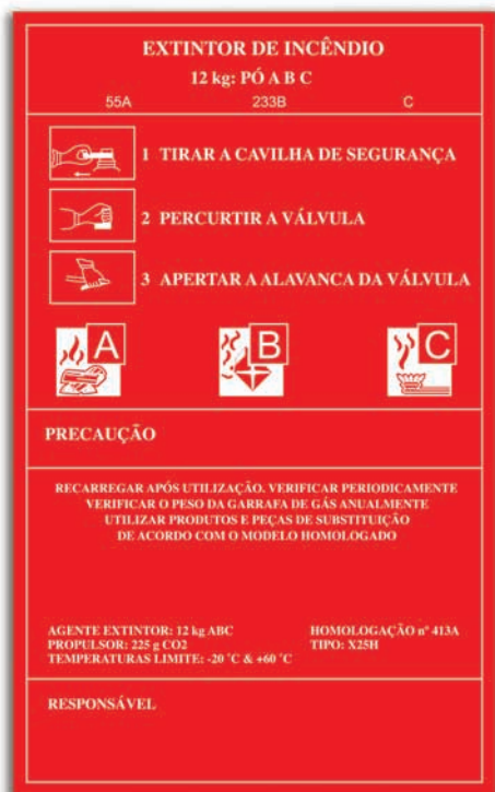
Fig. 32 Rótulo de um extintor.
