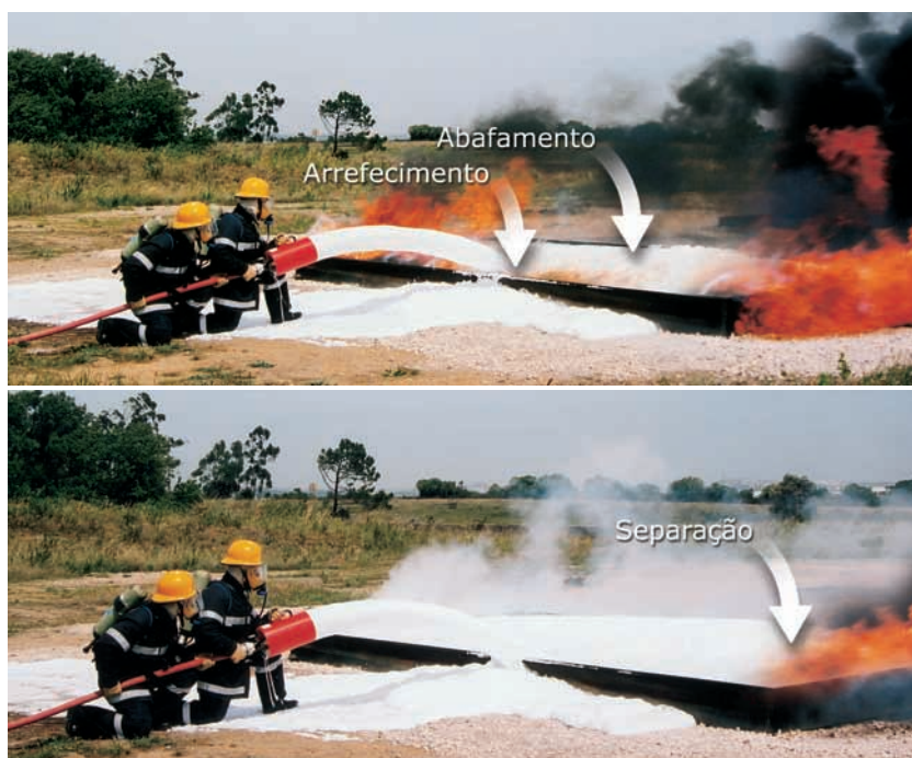
Fig. 21 A espuma extingue por arrefecimento e abafamento, separando os vapores de combustível das chamas.
