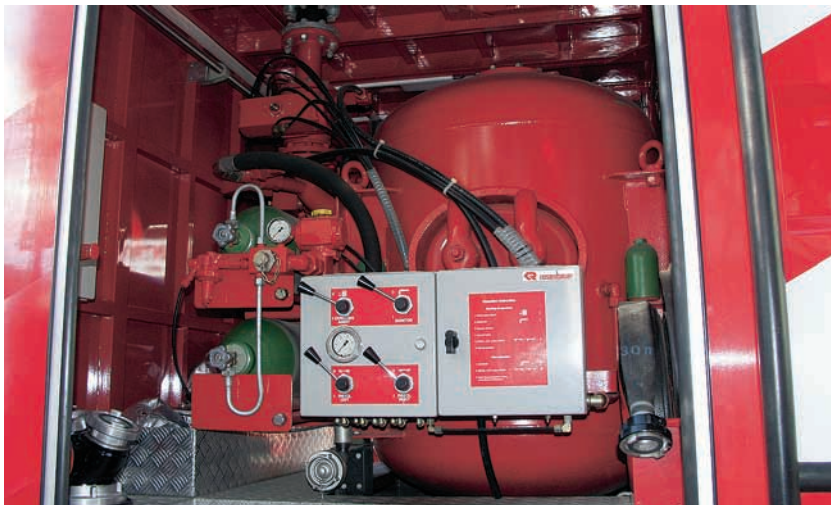
Fig. 30 Extintor de pó químico montado num veículo especial de combate a incêndios.
