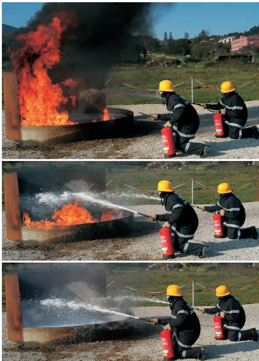
Fig. 50 Espuma projectada para a parede do recipiente.
