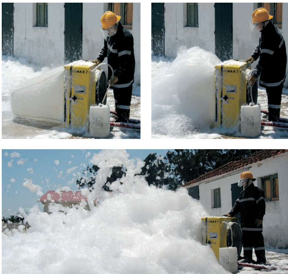
Fig. 26 Exemplo de um gerador de espuma de alta expansão.
