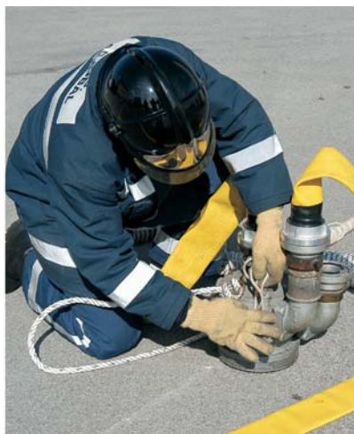
Fig. 110 O n.º 1 faz a ligação das espias de suspensão e descarga da coluna de água.
