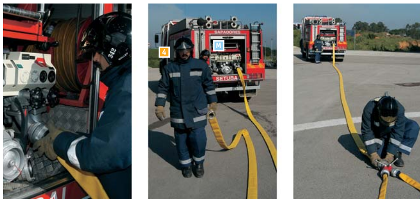
Fig. 48 Ligação do lança de 70 mm pelo n.º 4.
