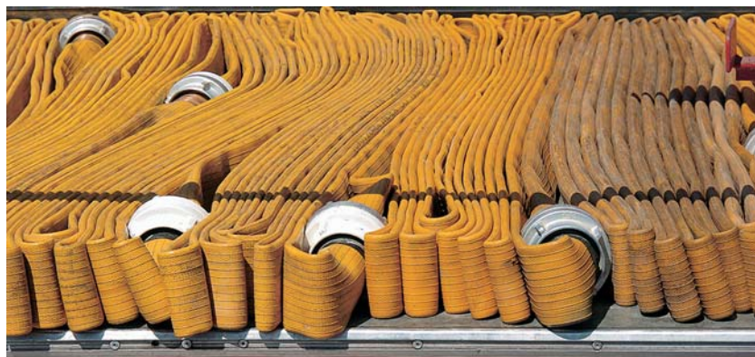
Fig. 75 Forma correcta de colocar as mangueiras.
