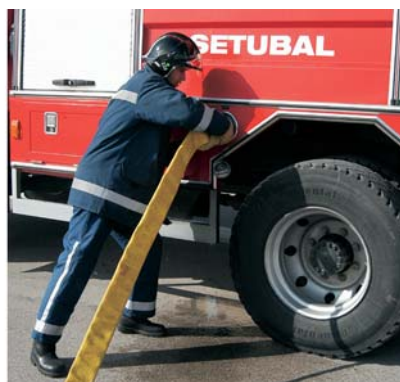
Fig. 107 O n.º 1 introduz a extremidade livre do lança de mangueira de saída de água da turbina no depósito de água do veículo ou na entrada de abastecimento.
