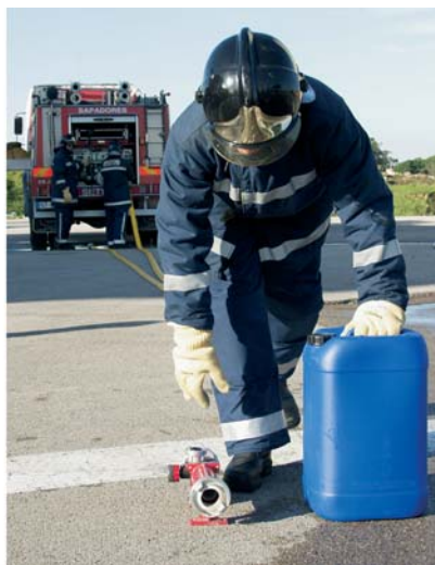
Fig. 69 Colocação do doseador/misturador e recipiente de espumífero pelo n.º 3.
