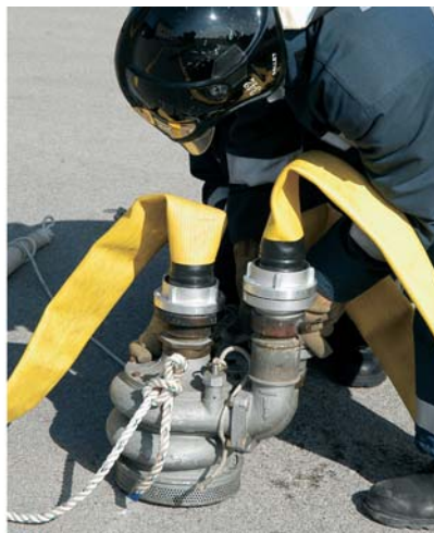
Fig. 111 O n.º 2 faz a ligação dos lanços de mangueira de 70 mm à saída da bomba.
