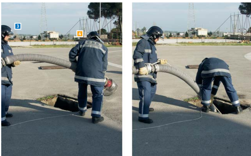
Fig. 94 O n.º 4 lança os chupadores à água, enquanto o n.º 3 os segura com a espia de trabalho.
