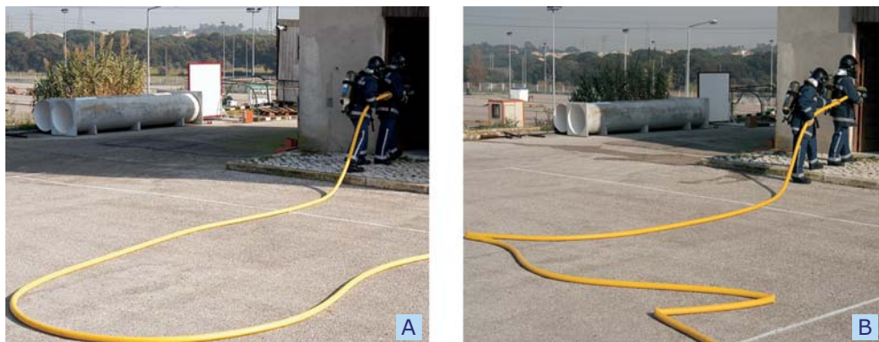
Fig. 19 Devem ser evitados estrangulamentos. A – Correcto; B – Incorrecto.
