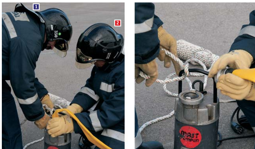
Fig. 102 O n.º 1 amarra as espis e o n.º 2 liga o lança de mangueira.
