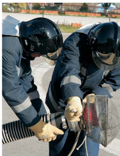
Fig. 91 O n.º 3 coloca o cesto e prende-lhe a espia de trabalho com um nó de barqueiro.
