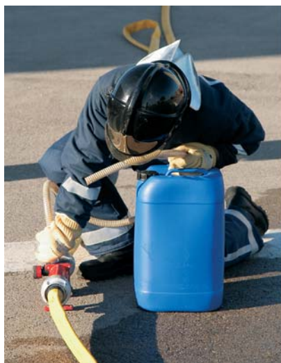
Fig. 70 Ligação do tubo de aspiração de espumífero pelo n.º 3.
