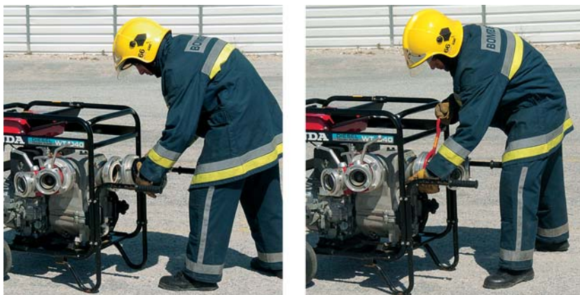
Fig. 96 O n.º 1 faz a adaptação do conjuntor à entrada da bomba.
