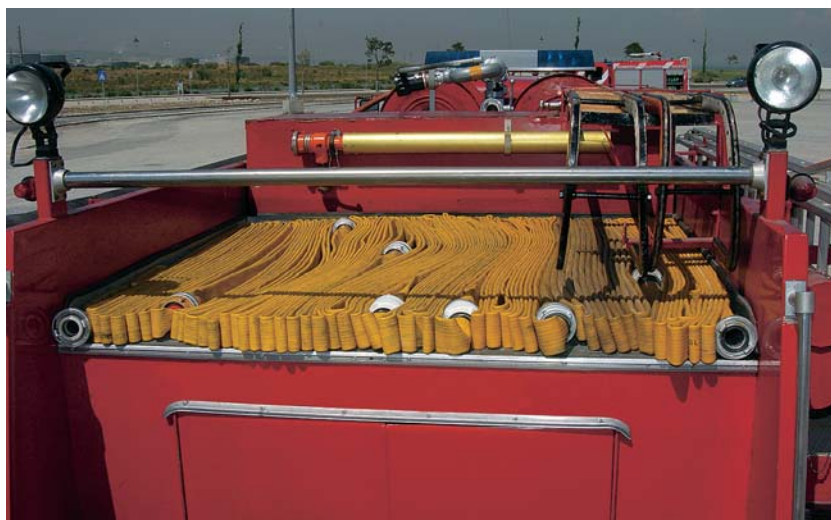
Fig. 74 Vista geral do compartimento de mangueiras.
