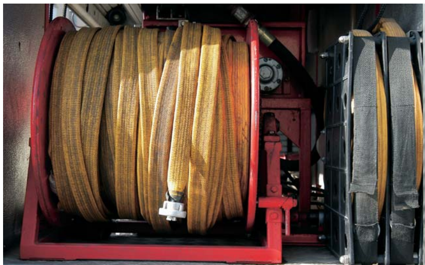
Fig. 78 Carretel com lanços de mangueira de 25 mm pré-ligados.
