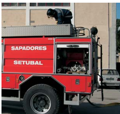
Fig. 107 O n.º 1 introduz a extremidade livre do lança de mangueira de saída de água da turbina no depósito de água do veículo ou na entrada de abastecimento.
