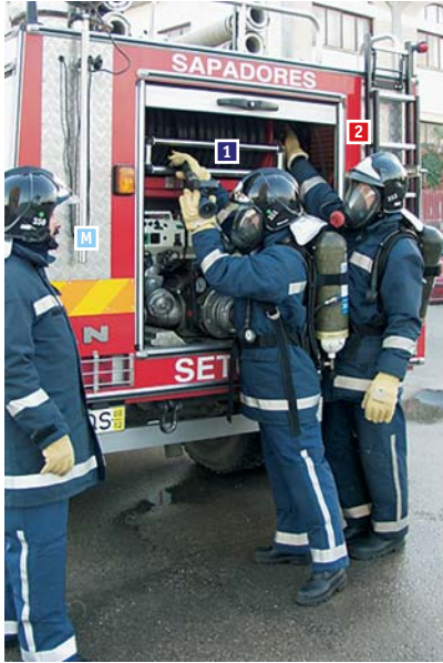
Fig. 57 O n.º 1 retira a agulheta enquanto o n.º 2 destrava o carretel.
