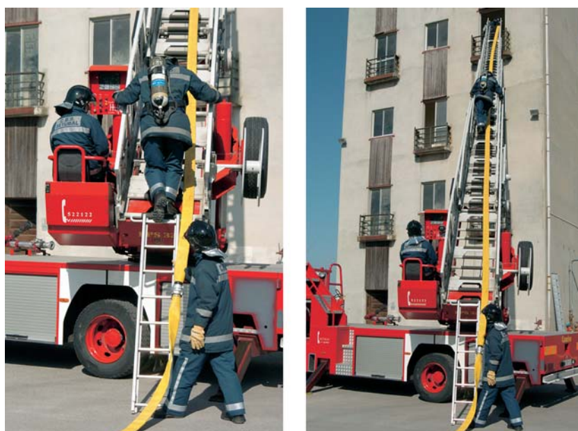
Fig. 72 Montagem de uma linha de mangueiras por escada giratória.
