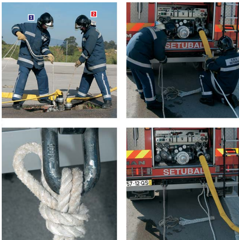
Fig. 112 Os n.ºs 1 e 2 amarram as espias a um ponto fixo.
