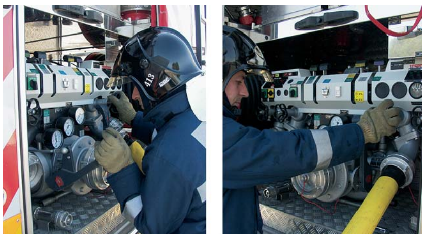
Fig. 64 O motorista efectua a abertura e regulação da pressão da bomba.
