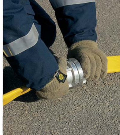
Fig. 13 Ligação de dois lanços de mangueira de 45 mm.
