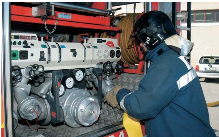
Fig. 108 O n.º 2 liga o lanço de mangueira de 70 mm à saída da bomba de incêndio do veículo.
