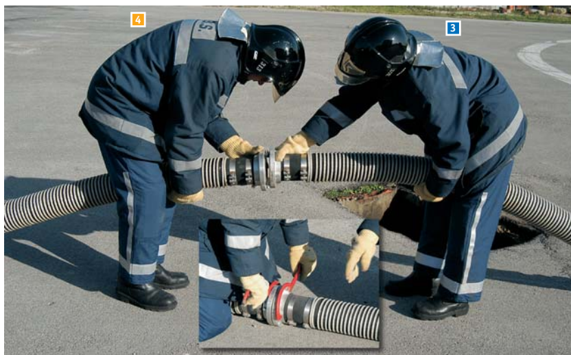
Fig. 88 Ligação dos corpos de chupadores feita pelos n.ºs 3 e 4.
