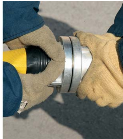
Fig. 14 Ligação de dois lanços de mangueira de 70 mm.
