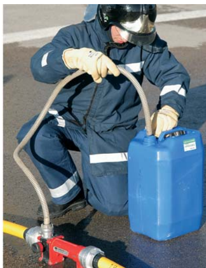
Fig. 70 Ligação do tubo de aspiração de espumífero pelo n.º 3.
