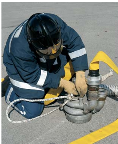
Fig. 110 O n.º 1 faz a ligação das espias de suspensão e descarga da coluna de água.
