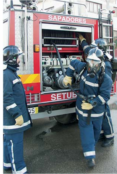
Fig. 57 O n.º 1 retira a agulheta enquanto o n.º 2 destrava o carretel.
