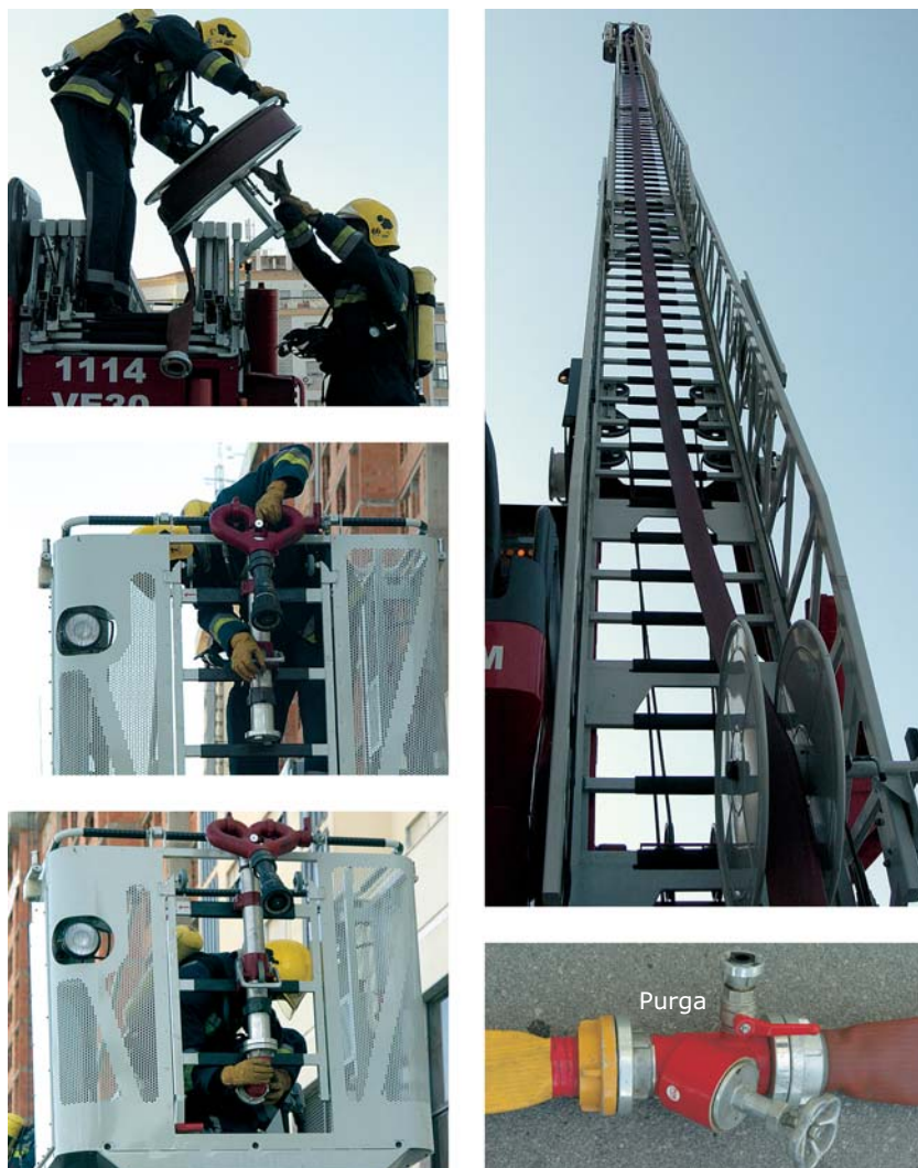
Fig. 73 Utilização do tambor de mangueiras e montagem do monitor.
