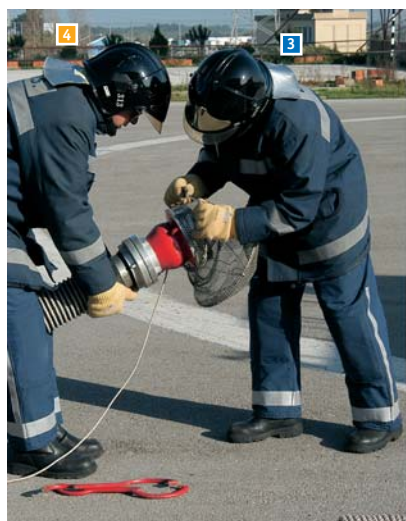
Fig. 91 O n.º 3 coloca o cesto e prende-lhe a espia de trabalho com um nó de barqueiro.
