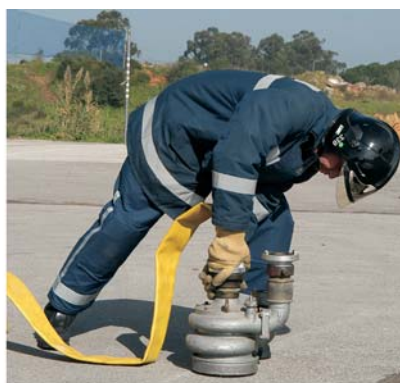
Fig. 106 O n.º 1 liga o lança de mangueira à saída da turbina da bomba hidráulica.
