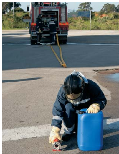
Fig. 69 Colocação do doseador/misturador e recipiente de espumífero pelo n.º 3.
