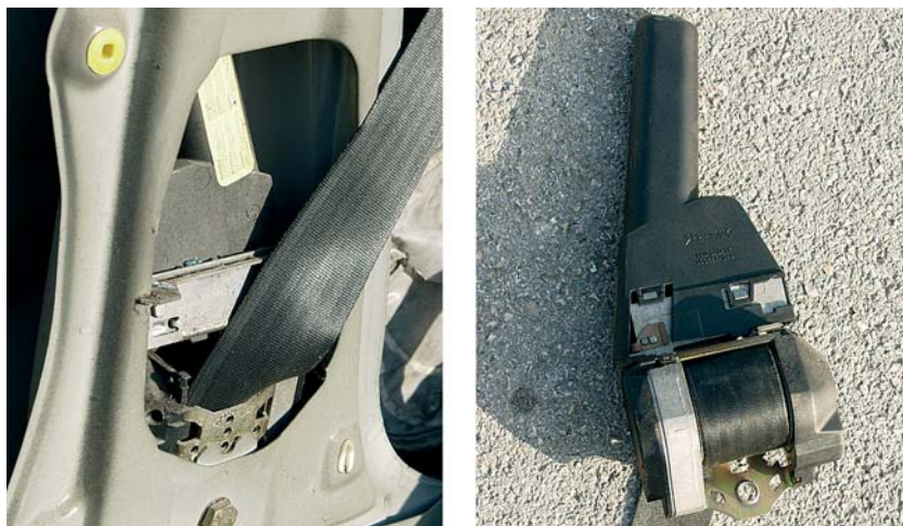
Fig. 53 Os pré-tensores têm por finalidade fixar o ocupante do veículo ao banco no momento do embate.
