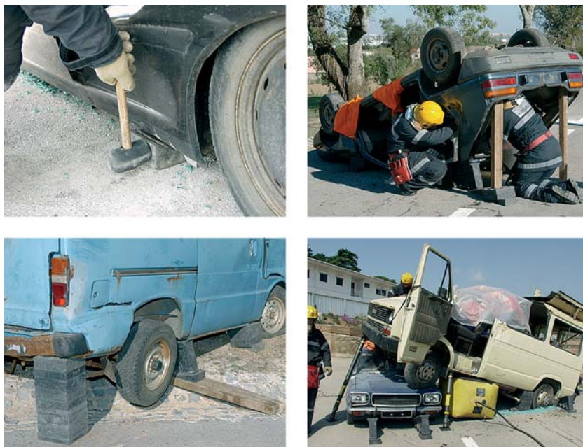
Fig. 54 A estabilização do veículo evita movimentações desnecessárias.
