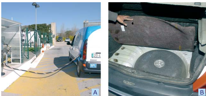
Fig. 42 Veículos a gás de petróleo liquefeito. A – Abastecimento; B – Depósito Tórico.
