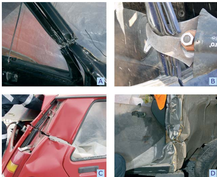
Fig. 37 Importância da identificação das estruturas do veículo na criação de espaço. A – Pilar A; B – Pilar B; C – Pilar C; D – Base do pilar A e painel lateral.
