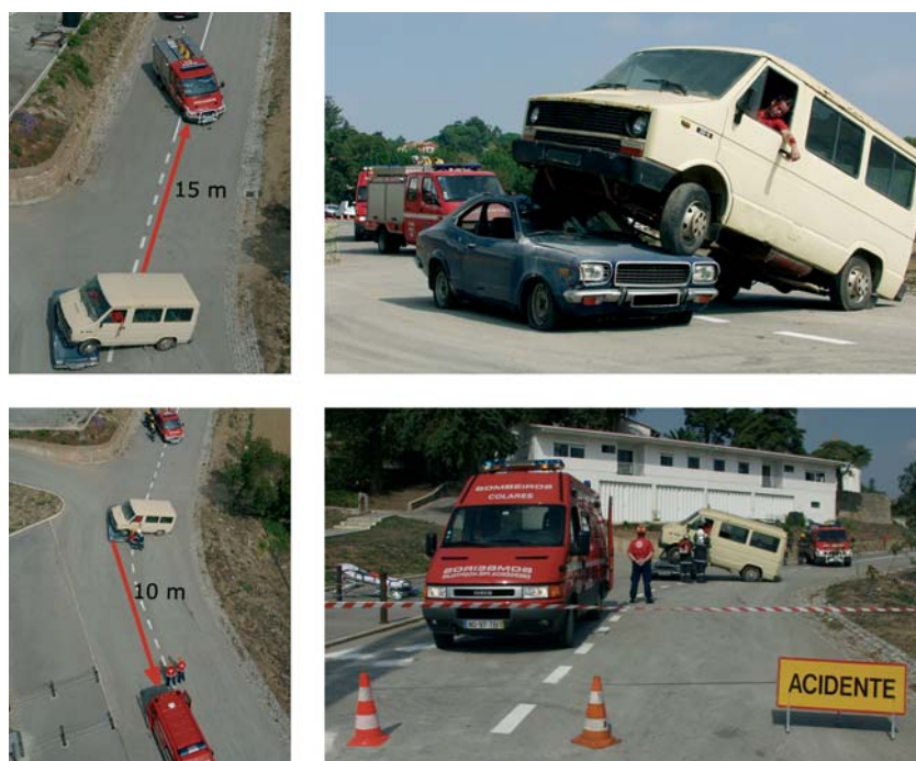
Fig. 4 Posicionamento defensivo dos veículos de socorro.
