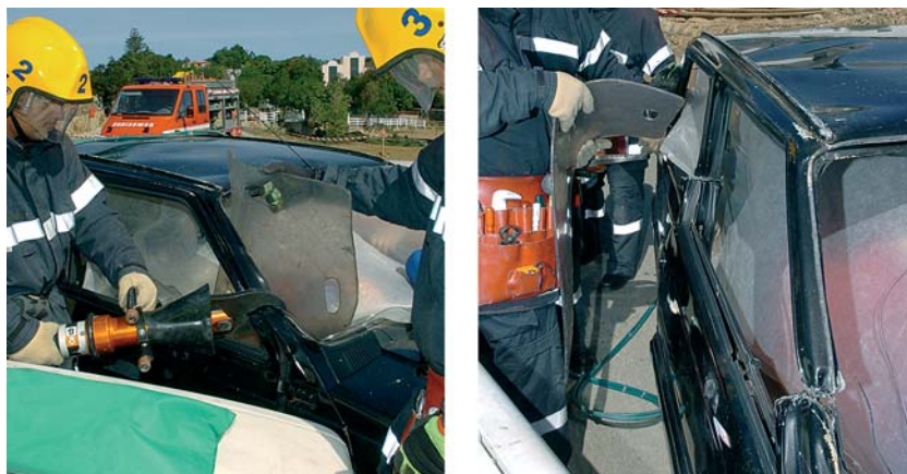
Fig. 64 Corte dos pilares A e B de ambos dos lados do veículo.
