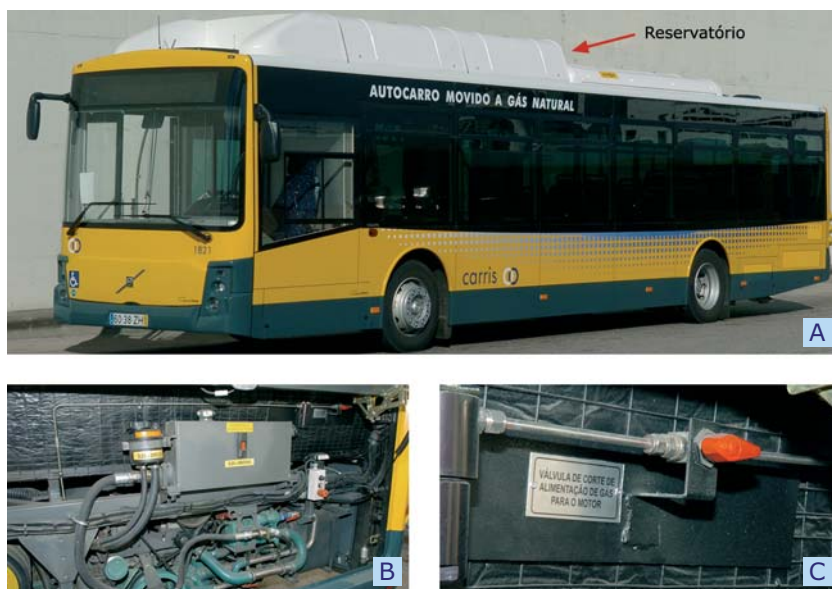
Fig. 43 Veículo a gás natural. A – Reservatórios de gás no tejadilho; B – Compartimento do Motor; D – Válvula de corte de alimentação de gás para o motor.
