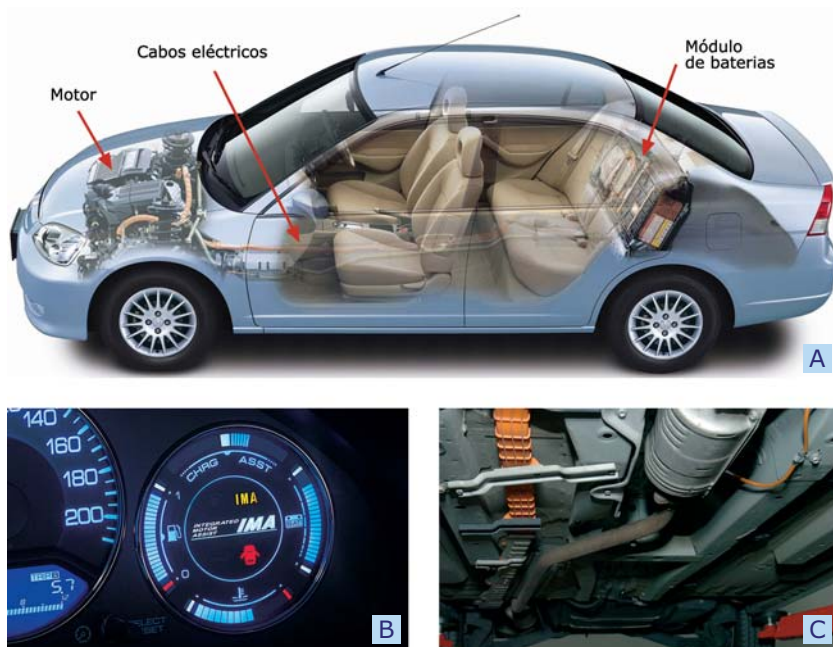
Fig. 44 Veículo híbrido. A – Exemplo de um sistema híbrido; B – Indicador do estado de carga do módulo de baterias e do combustível; C – Blindagem de cabos eléctricos.
