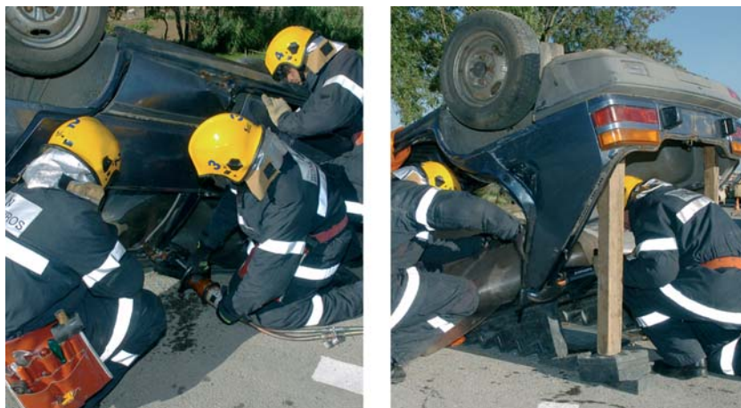
Fig. 94 Corte de pilares.
