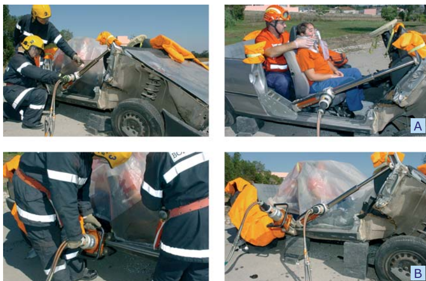
Fig. 83 Afastamento do tablier com o extensor. A - Utilizando como base de apoio o suporte do extensor; B - Utilizando como base de apoio o expansor.
