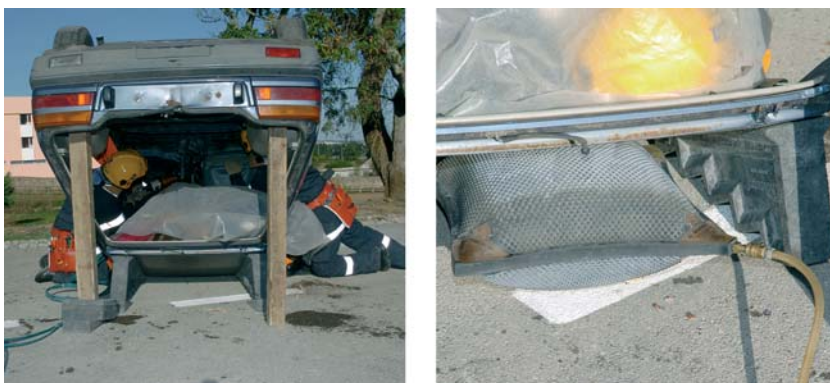
Fig. 93 Criação de acesso à vítima e colocação de almofada de alta pressão.
