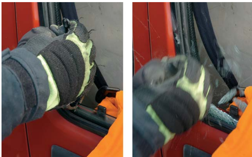
Fig. 50 Remoção de vidro da porta.
