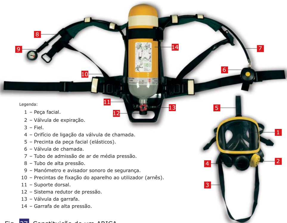
Fig. 27 Constituição de um ARICA.
