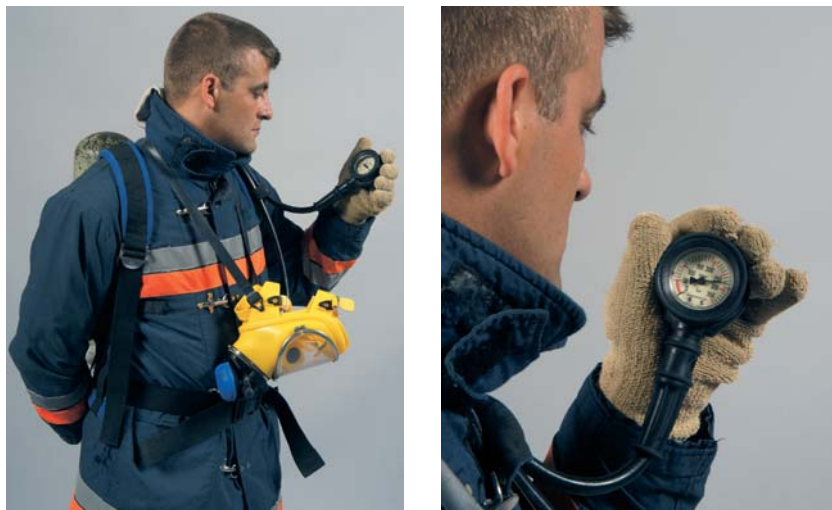
Fig. 45 Verificação da pressão do ar contido na garrafa.
