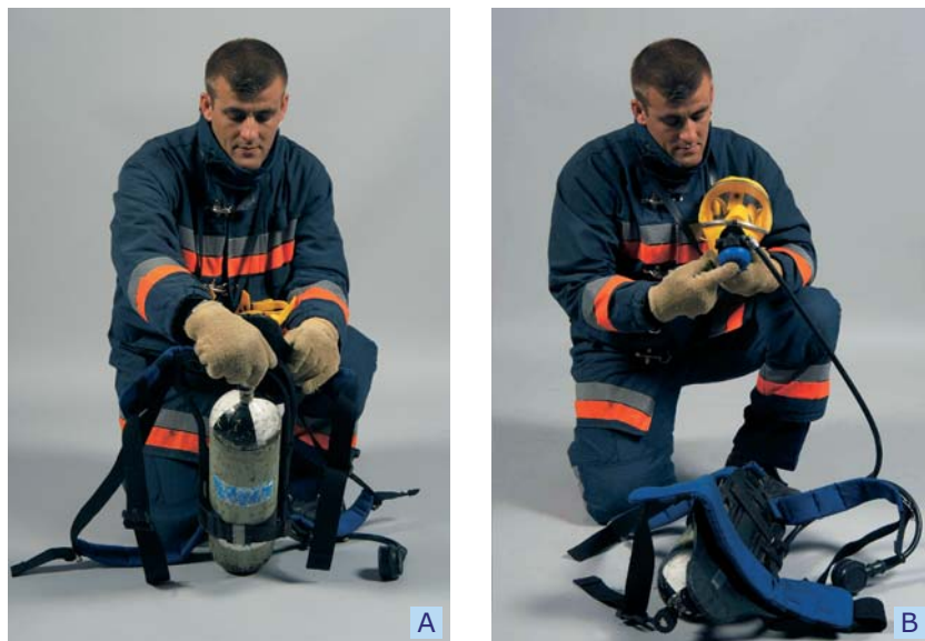
Fig. 58 A – Fecho da válvula da garrafa; B – Purga do ar retido no sistema.
