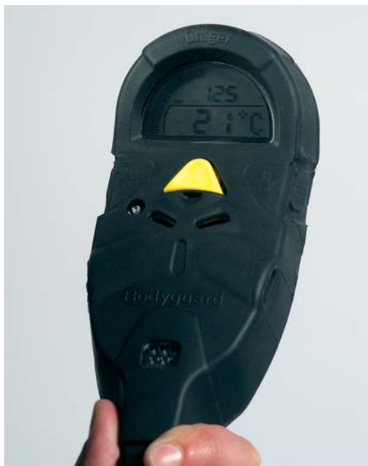
Fig. 33 Unidade de alarme e sinalização.
