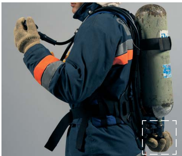
Fig. 44 Manobra de abertura da válvula da garrafa.
