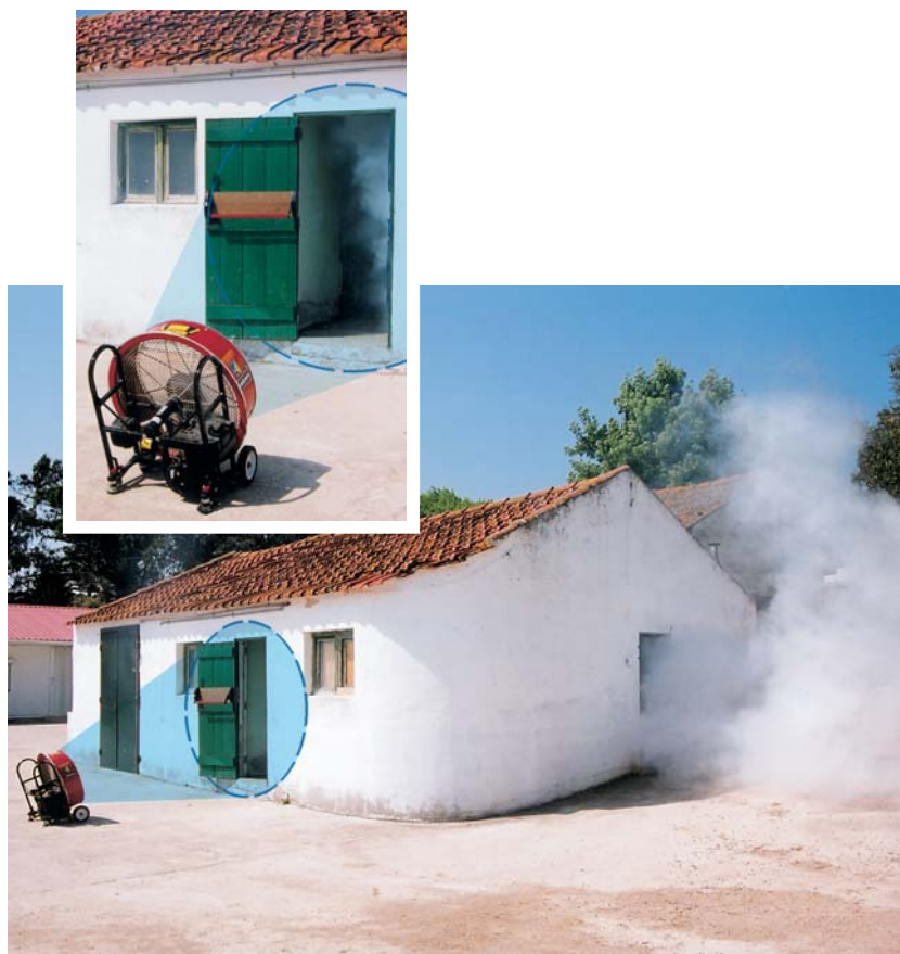
Fig. 25 O cone de ar deve cobrir completamente o ponto de entrada.
