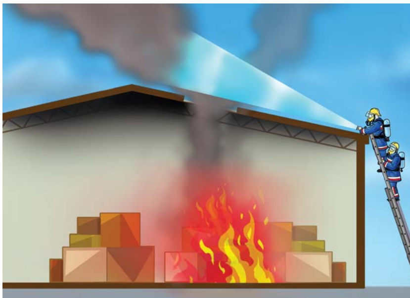
Fig. 17 Uma linha de mangueira a trabalhar paralelamente ao plano da cobertura.
