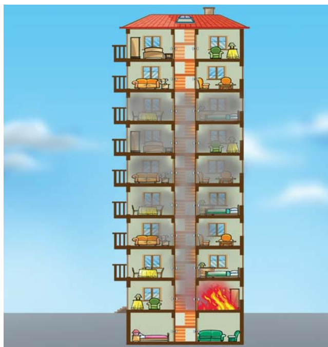
Fig. 7 Formação de camadas de fumo nos edifícios de grande altura.
