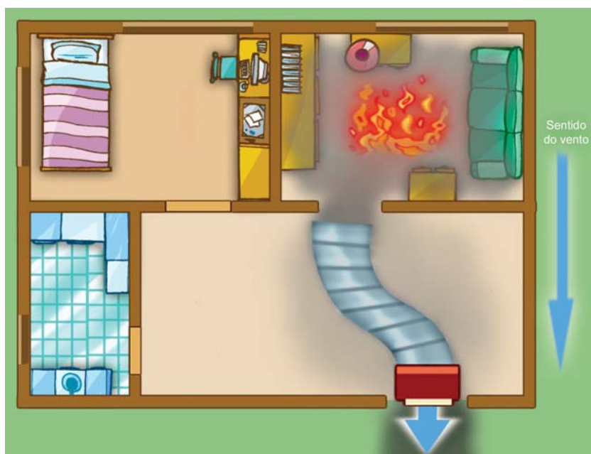
Fig. 23 A VPN utiliza exaustores para extracção de fumo.
