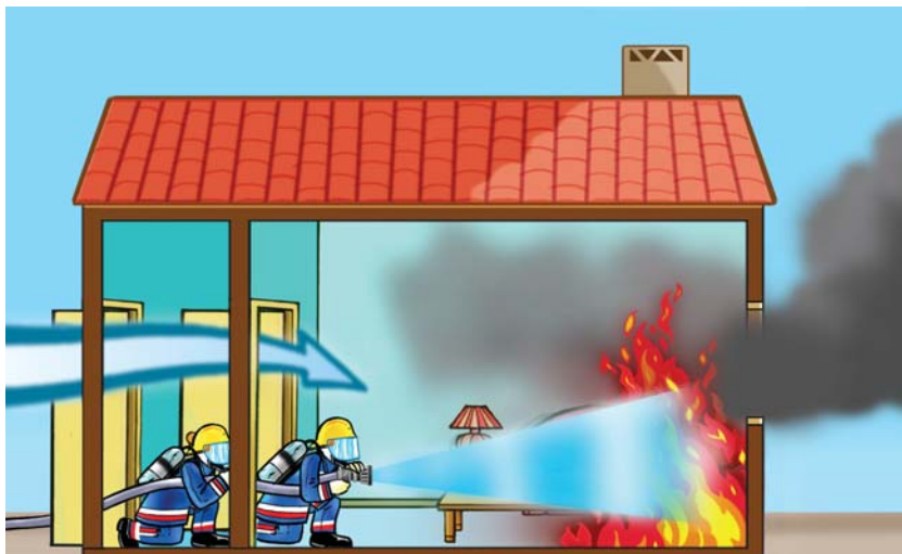
Fig. 21 O ar deve entrar apenas do lado oposto à saída do fumo.
