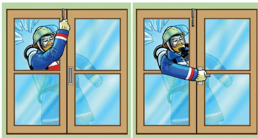
Fig. 27 Abertura de uma janela por quebra do vidro.
