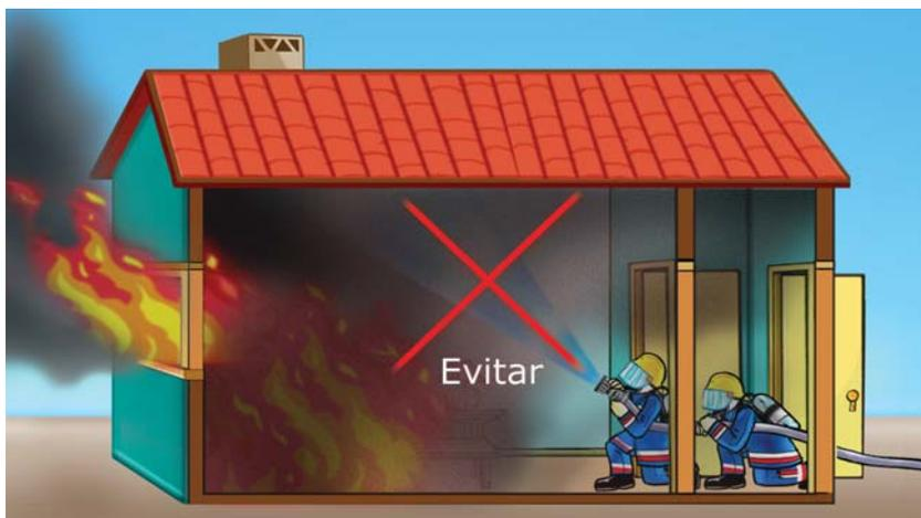
Fig. 10 Deve evitar aplicar-se a água sobre o fumo.
