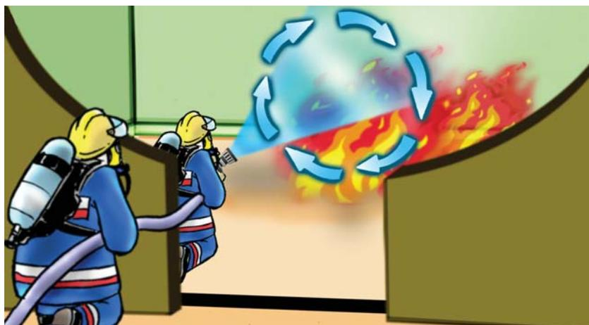
Fig. 21 Tática de aplicação da água pelo método de ataque combinado.
