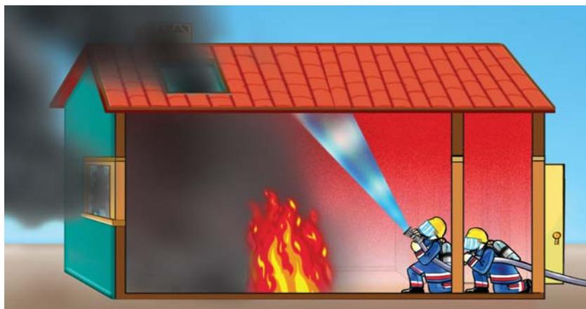
Fig. 19 Tática de aplicação da água pelo método de ataque indirecto.
