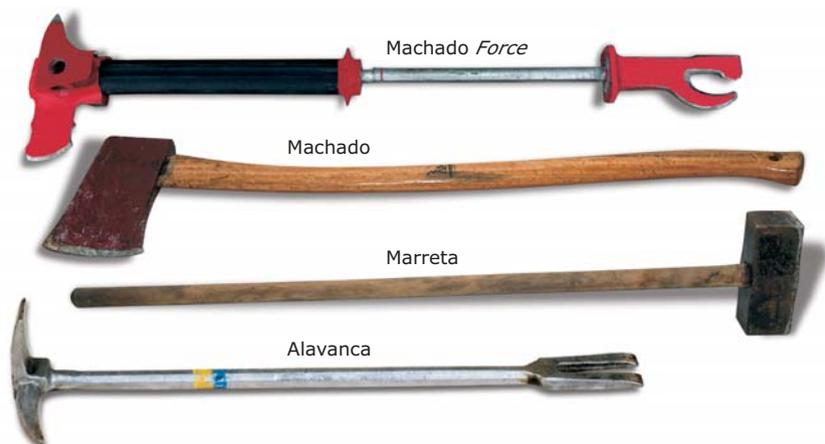
Fig. 25 Exemplo de ferramentas utilizadas para entrada forçada.
