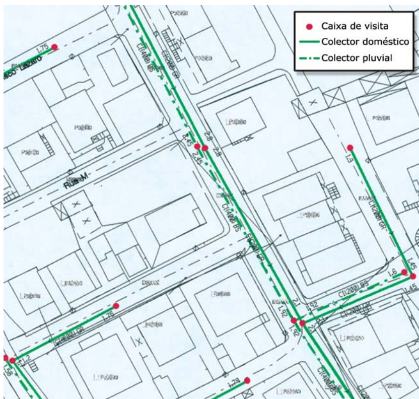
Fig. 37 Esquema de rede pública de águas residuais (domésticas e pluviais).
