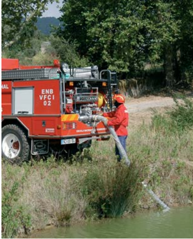
Fig. 15 Operação de bombagem a partir de um manancial.
