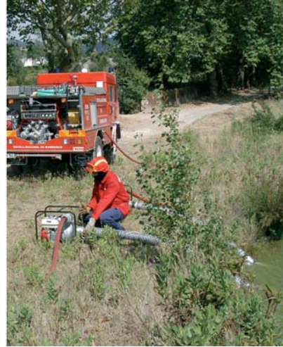
Fig. 15 Operação de bombagem a partir de um manancial.
