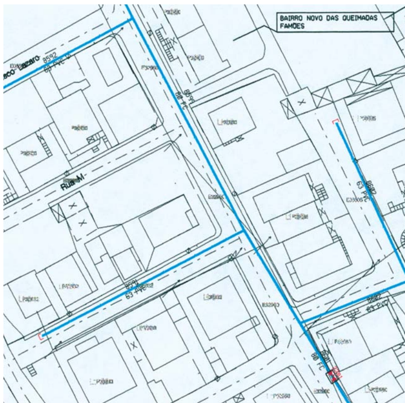
Fig. 9 Esquema de uma rede pública de distribuição de água.
