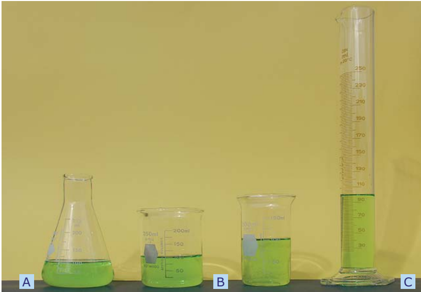
Fig. 2 A água ocupa a forma do recipiente que a contém. A – Vaso graduado; B – Copos graduados; C – Proveta graduada.
